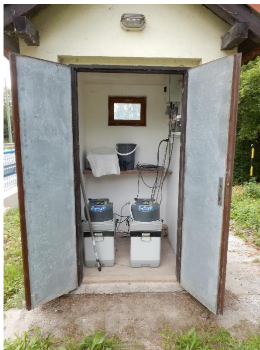
Obr. 5.4.2.3.2 Stanice Plaňany se vzorkovači ISCO
